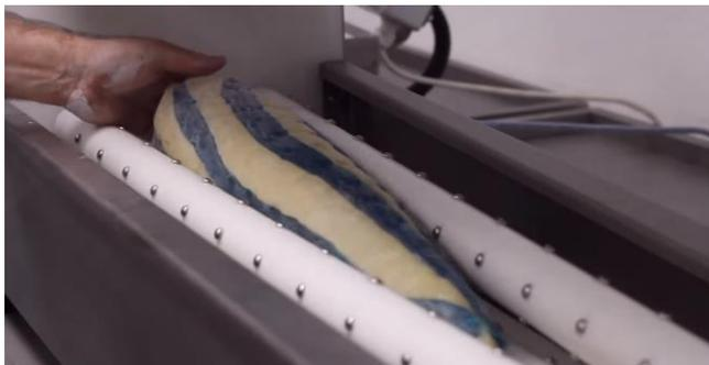
Вращение в одну сторону или с реверсированием придается веретенам индивидуально в зависимости от желаемого рисунка карамельного жгута и скорости выработки батона. Если скорость выработки батона высокая, то можно использовать вращение в одну сторону. Для предотвращения «завинчивания» рисунка батона лучше использовать реверсивный режим вращения. Изменение режимов вращения можно осуществлять без остановки машины путем переключения соответствующей ручки на блоке управления.
