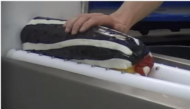
В процессе обкатки карамельный батон вытягивается и принимает форму конуса, ось которого имеет уклон к месту выхода жгута. Тонкий конец конуса достается руками и вытягивается в сторону выходной прорези в конце вращающихся веретен машины.
