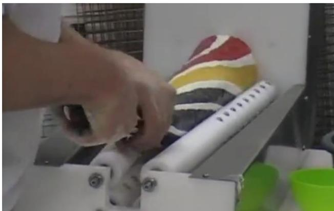
Затем конец карамельного батона вытягивается вручную в жгут необходимого диаметра, отрезается по нужной длине, из которого формируется конфета либо далее подается на жгутокалибрующую машину. Толщина жгута, выходящего из обкаточной машины, достигается путем калибрования (вытягивания) руками.
